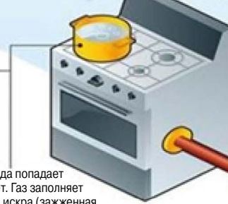
От долгой или неправильной эксплуатации происходит разрыв шланга, соединяющего газовую магистраль с плитой. Газ постепенно заполняет помещение. Искра – взрыв
