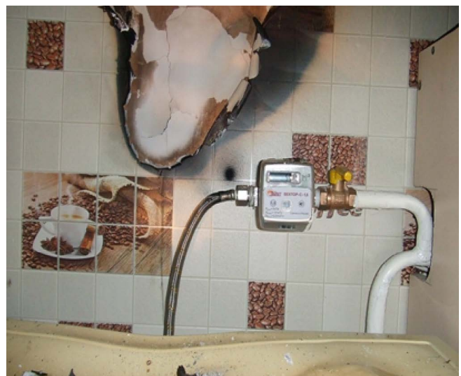
Последствия факельного горения в результате разгерметизации гибкого соединительного шланга.
